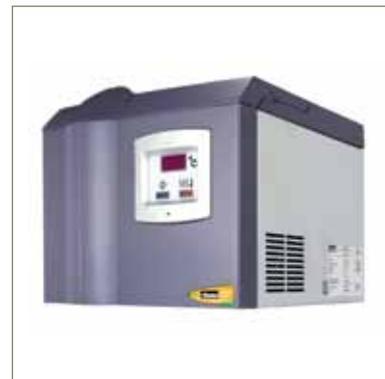
Les générateurs d'air zéro UHP-ZA Parker domnick hunter produisent un flux constant d'air sans impureté organique à partir d'une source d'air comprimé sec externe et offre des limites supérieures de détection inégalées par les autres modes d'alimentation. Les débits varient entre 1 l/min et 30 l/min.
